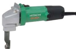
Diseño renovado con el cuerpo-empuñadura más reducido de su clase, 184 mm. de diámetro, lo que le otorga una mayor comodidad de trabajo. Muy ligera, 1,6 kg. Diseño renovado. Tiene 3 posiciones de la matriz que le permiten cortes rectos, a derecha y a izquierda. Ideal para acero acanalado y trapezoidal.
