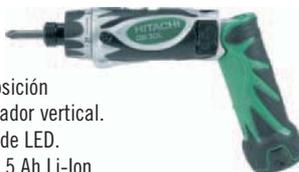
Convertible de la posición de pistola a atornillador vertical. Indicador luminoso de LED. Batería de 3,6 V - 1,5 Ah Li-Ion. Inserción de 6,35 mm. Hex. Máximo apriete de 5 Nm. 22 Posiciones de par de apriete.
