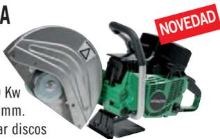
Tronzadora de 3,0 Kw con disco de 355 mm. Se pueden adaptar discos con eje de 20 mm y de 25,4 mm. con el anillo reductor. Motor de 2 ciclos a gasolina con sistema ECO de ventilación. Ligera y manejable. Doble sistema de filtros de aire de larga duración que impiden la entrada de cualquier partícula de polvo. Dispone de amortiguadores que reducen las vibraciones y facilitan el trabajo.
