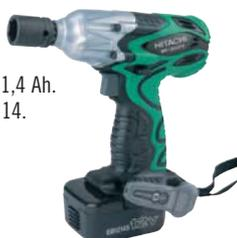
Batería de 12 V. Batería de 1,4 Ah. Capacidad de perno M 6-M 14. Máximo apriete de 130 Nm. Indicador luminoso de LED. Empuñadura comfortable.
