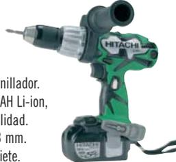
3 Funciones: Taladro, taladro con percusión y atornillador. Tensión 18V. Batería de 3,0 AH Li-ion, de peso ligero y gran durabilidad. Porta-brocas sin llave de 13 mm. 22 posiciones de par de apriete. Máximo apriete de 64 Nm (posición de taladro). Motor equipado con ventilación con alta resistencia a al sobrecarga. Empuñadura comfortable. Freno electrónico. Correa de seguridad. Diseño innovador.
