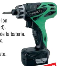
Batería de 10,8 V - 1,5 Ah Li-Ion (Peso ligero, larga durabilidad). Indicador luminoso del estado de la batería. Inserción de 6,35 mm , ¼ Hex. Máximo apriete de 24,7 Nm. 21 Posiciones de par de apriete. Diseño innovador.
